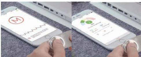
〈그림 11〉 손가락을 이용한 심박측정기
