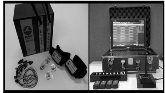
그림 5. 근전도(左) 및 관성센서 측정기기(右) Fig. 5. Measuring device of EMG(left) and IMU sensors (right).
