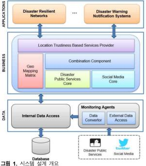
그님 1. 시스템 설계 개요 Fig. 1. The overview of the design of our system
