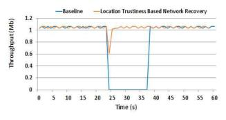
그림 2. 재난 상황헤서 처리량 측정 Fig. 2. Throughput measurement under a disaster event
