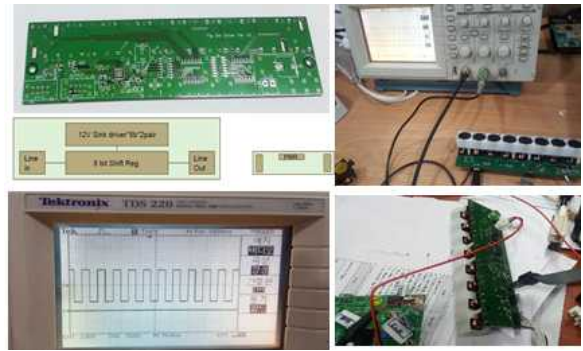
그림 12. 1x8 원형 자석표시기 펄스 펌웨어 시연 Fig. 12. 1x8 Electromagnetic status indicators Demonstration of pulse firmware
