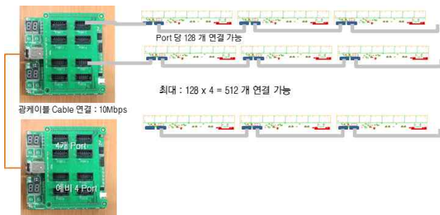
그림 14. 원형 자석표시기 포트별 병렬 조립도 Fig. 14. Electromagnetic status indicators Parallel assembly diagram for each port
