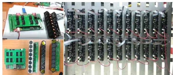
그림 13. 1x8 원형 자석표시기 모듈 멀티 연결 Fig. 13. 1x8 Electromagnetic status indicators module multi-connection
