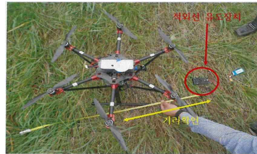
그림 6. 적외선 센서를 이용한 자동 착륙 Fig. 6. Automatic landing with IR LOCK Sensor
