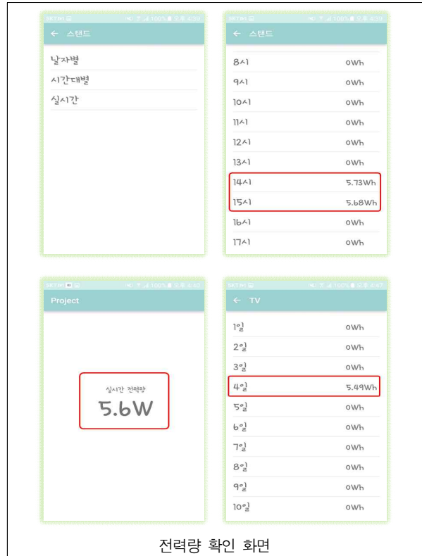
그림 11. 스마트 콘센트 시스템의 제어 화면 및 전력량 확인 화면 Fig. 11. Control Screen and Power Amount Confirmation Screen of Smart Outlet System
