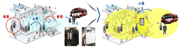
그림 3. 화재현장 내 UHF 무선통신 중계장비 개발 사례 Fig. 3. Case study of Development of UHF wireless communication relay equipment in fire scene
