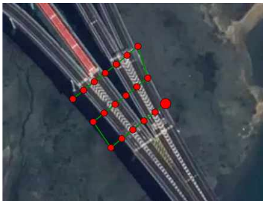
그림 2. 팬텀 4 프로의 비행경로 계획 Fig. 2. Setup flight plan of Phantom 4 Pro before obtaining images
