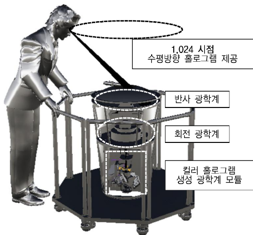
(그림 5) 한국전자통신연구원이 개발한 4.5인치급 컬러 디지털 홀로그래픽 디스플레이 시스템[11]
