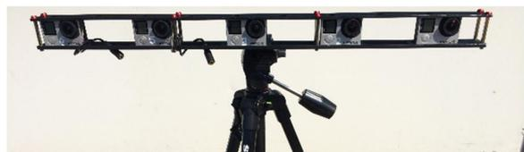
(그림 3) 평행배치 고정 리그 장치(ETRI 제작)
