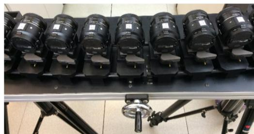
(그림 2) 평행/집중배치 제어 가능한 리그 장치(ETRI 제작)
