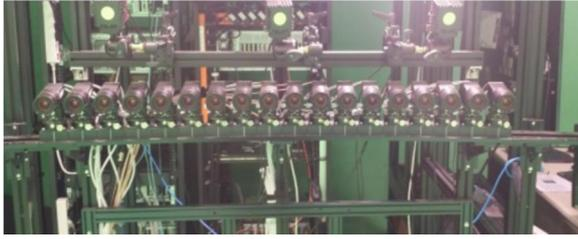
(그림 11) 다시점 영상 획득용 카메라 리그(ETRI 개발)
