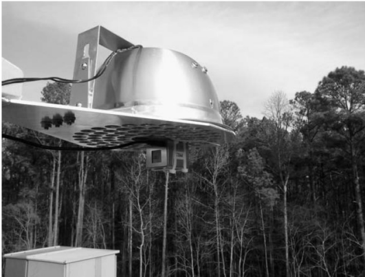
그림 12 Dylos DC1100센서 설치 사진(EPA/600/R-14/464)
