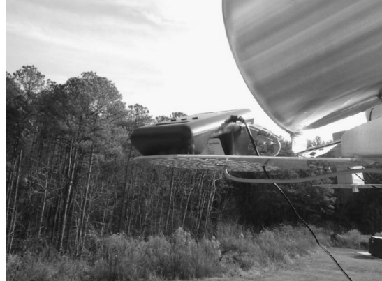
그림 12 Dylos DC1100센서 설치 사진(EPA/600/R-14/464)
