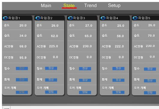
그림 4. 리모트 터치 알람 제어 프로그램의 센서 상태 표시
