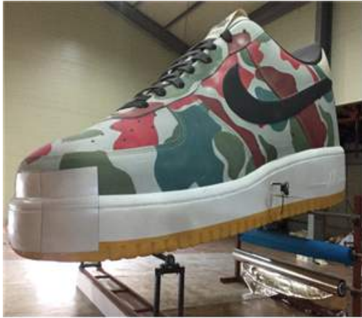
<그림 5> 제작된 0(Zero) 부력의 공기조형물
