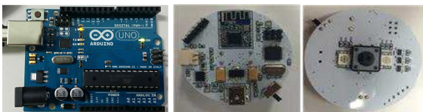
그림 7. 아두이노 우노 보드와 버튼 앞 뒤 설계 Fig. 7. Arduino Uno board and designed button board Front and Back
