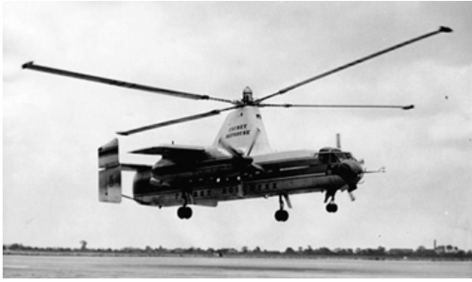
Fig. 1. Tip-jet driven rotor.
