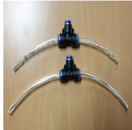
Fig. 4. Hollow fiber membrane test modules (Lab. scale).
