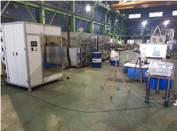
그림 13. CRW 전자파 차폐 측정 Fig. 13. CRW electromagnetic shielding effectiveness measurement.
