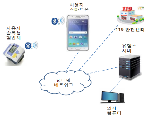
그림 1. 실시간 혈압 모니터링 u-헬스케어 시스템
