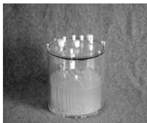
Fig. 2 Flangeless Esser PET phantom
