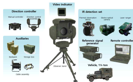
그림 2. 열상감지기 주요 구성품 Fig. 2 Components of TOD
