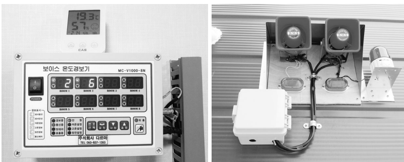
▲ 각 계사마다 적정 온도를 정해놓고 온도가 이상이 있거나, 정전 등 문제가 생길 경우 전화, 문자, 경보기로 알려주는 주식회사 다르마의 보이스 온도 경보기
