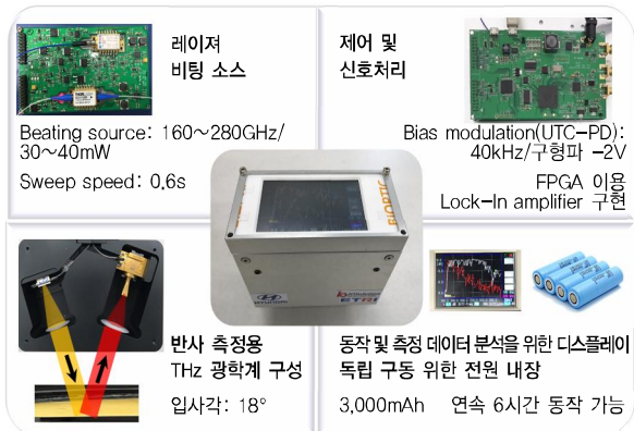
(그림 5) 휴대용 THz 누수 검출 시스템 구성도
