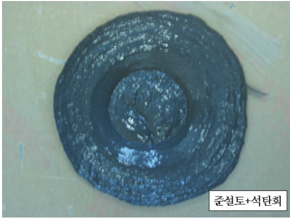
Fig. 2. 준설토+석탄회+시멘트의 유동성 시험.
