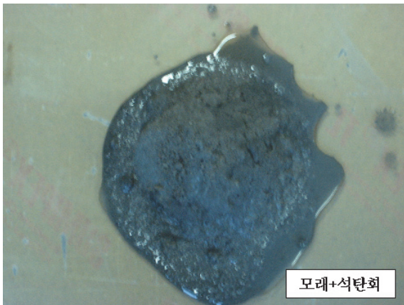
Fig. 4. 모래+석탄회+시멘트의 유동성 시험.
