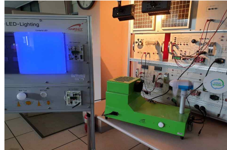
<그림 6> LED 구동 BESS 실험
