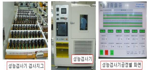
Fig. 7. Electrical performance tester. 그림 7. 센서통합히터의 전기적 성능검사기
