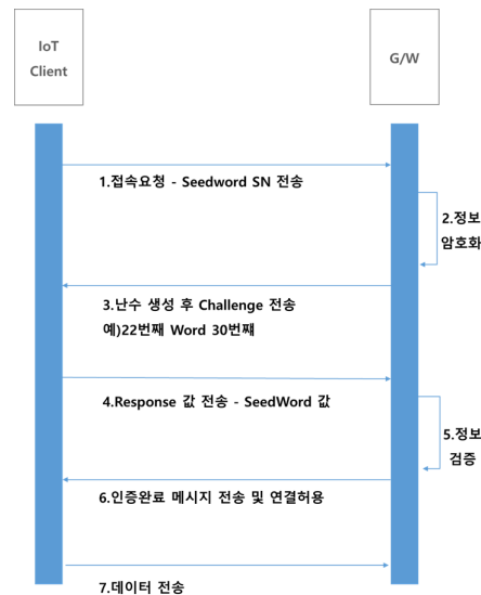
그림 6. Challenge and Response 방식 인증 프로세스 Fig. 6. Challenge and Response authentication process
