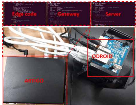
그림 8. 시뮬레이션 환경 (ARTiGO A820과 ODROID) Fig. 8 Simulation environment (ARTiGO A820 and ODROID)
