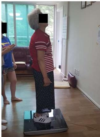
그림 2. 안전한 신발을 착용한 상태의 후방 안정성의 한계 측정 모습
