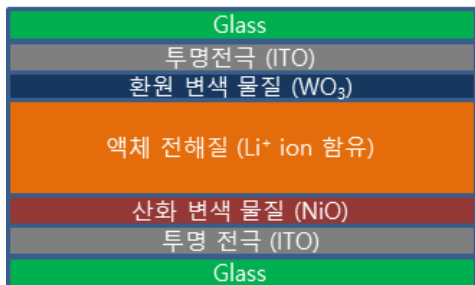
그림 9 WO 3 와 NiO를 이용한 무기물계 전기변색소자의 개념도
