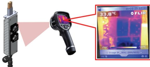
Fig. 7(a). 열화상 카메라 온도 측정.
