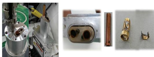
Fig. 3. Heater Rod 유착 사진.
