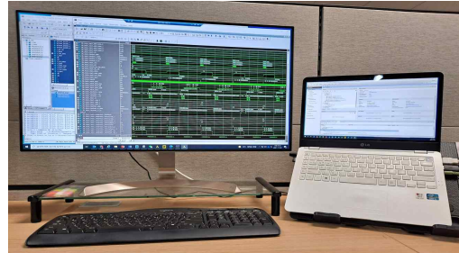
<그림 8> 압축/해제 하드웨어 블록의 시뮬레이션 개발 환경. (좌) Modelsim을 이용한 기능 검증, (우) Vivado를 이용한 합성 검증
