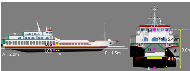
Fig. 12. Height of GM, KG, KM.
