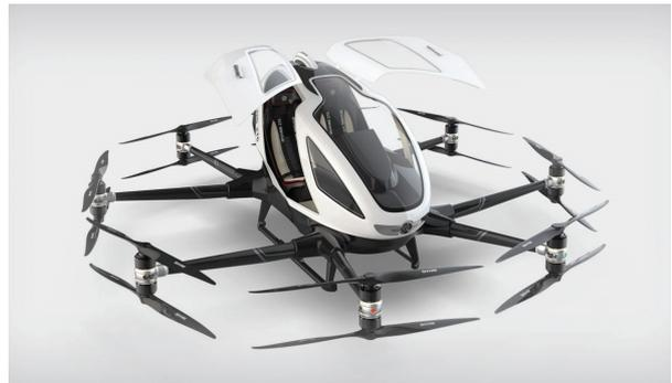
Fig. 3. Multirotor type (EHang 216)
