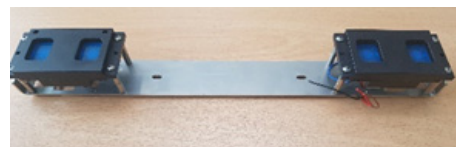
Fig. 4. IR-UWB radar sensor
