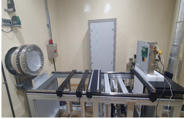
그림 5. RFSoc 양성자 빔 조사 시험 셋업 Fig. 5. RFSoc board proton radiation test setup
