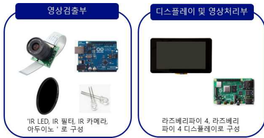
그림 1. 정맥 검출 장비 H/W 부품 구성 Fig. 1. Configuration of vein detection equipment H/W parts
