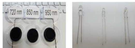
그림 4. 실험에 사용한 근적외선 Filter 및 LED Fig. 4. NIR(Near-infrared) Filter and LEDs used in the experiment
