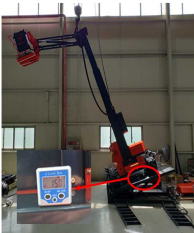
그림 14. 전도 시험 결과 (15도 전도할 수 있음을 확인) Fig. 14. Conductivity test results (confirm that it can conduct 15 degrees)
