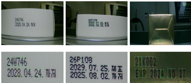
그림 6. 라벨 데이터셋의 구조 Fig. 6. Structure of label dataset
