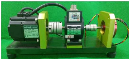
그림 8. 발전기 검사장치 Fig. 8. Dynamo-Tester of Generator
