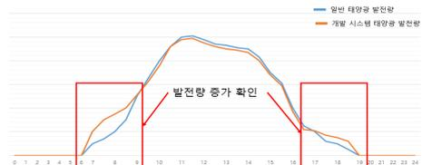
그림 14. 개발시스템 및 일반 태양광전시스템의 발전량 비교
