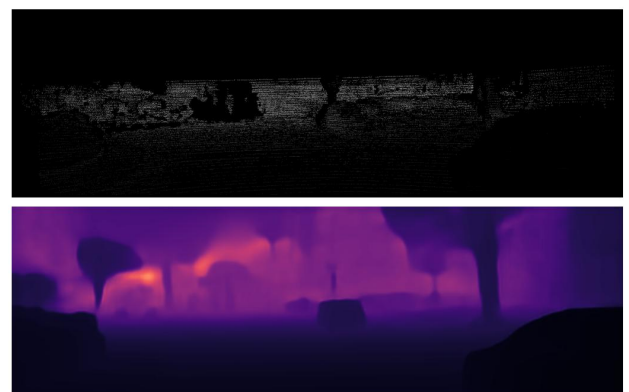
그림 3. Lidar projection과 Monodepth2 추론 뎁스 맵 Fig. 3. Lidar projection and Monodepth2 depth map
