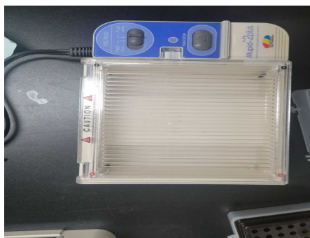
그림 4. 전기영동에 사용된 Mupid-2plus Fig. 4. Mupid-2plus used for electrophoresis
