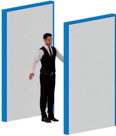
그림 5 패널형 보안검색 시스템 개념도
