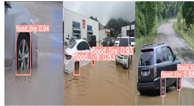
그림 7. YOLOv5를 사용하여 침수된 차량의 타이어 검출 Fig. 7. Using YOLOv5 to detect tires on flooded vehicle
