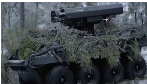
그림 4. 독일 무인 전투로봇 'Mission Master' Figure 4. Germany unmanned combat robot 'Mission Master'
