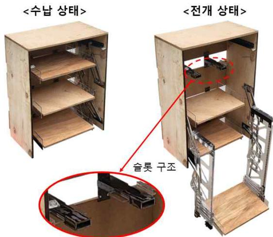
그림 11. 높이 조절 상부장 최종 형상 및 작동 과정
