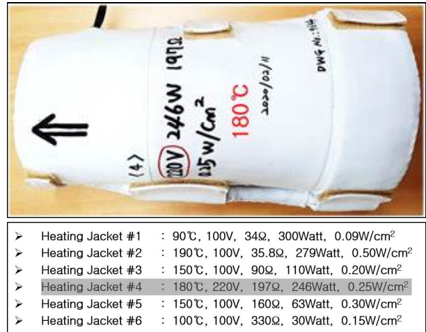
그림 4. 히팅자켓의 전기적 사양 Figure. 4. Heating Jacket Specifications
