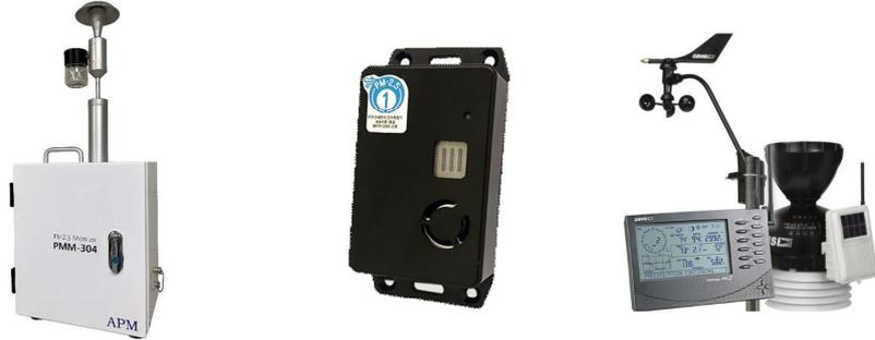
DSM101 10대(1~10지점)는 그림 1의 노란 점선으로 표시된 5개 지점에서 도로를 중심으로 양쪽 보행로의 가로수에 고정하여 측정하였다. 노란 점선으로 표시한 지점은 도로를 기준으로 양쪽의 토지피복이 다른 지역으로 선정하고자 하였다. 모든 기기는 보행자 평균 호흡 위치인 1.5 m 높이(Li et al., 2023)에서 측정되도록 설치하였다(그림 4).
