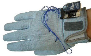
그림 4. 개발된 데이터 글러브 시스템의 모습. Fig. 4. Appearance of the developed data glove system.
